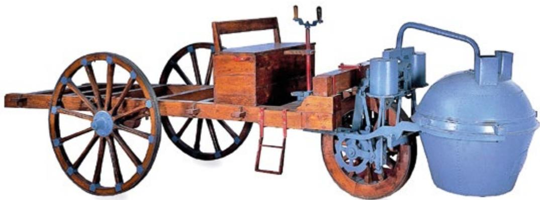
*Il carro a tre ruote con propulsione a vapore di Nicolas Joseph Cugnot*
