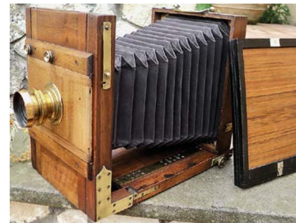
Macchina fotografica ambulante per negativi in lastre di vetro. Erano mastodontici apparecchi fotografici a fisarmonica, che si allungavano o accorciavano per la messa a fuoco. Foto: internet
