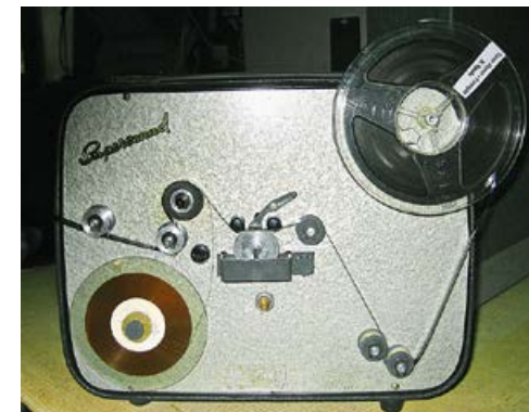
Mi sono anche procurato un macchinario per incollare sulla pellicola il nastro del sonoro, dallo spessore di 0,8 mm. In alto a destra si vede la pellicola già montata, al centro la bacinella della colla e in basso a sinistra il nastro del sonoro. Il tutto veniva trainato dal proiettore. Tutto fatto in casa!
