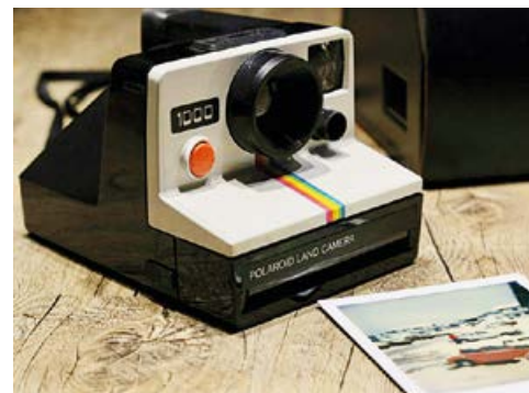
La fotocamera istantanea a sviluppo immediato: una volta effettuato lo scatto si estrae dall'apparecchio un foglio plastico che, messo alla luce, in pochi secondi si vede lo sviluppo della rispettiva immagine. Questo è uno dei primi modelli della marca Polaroid
