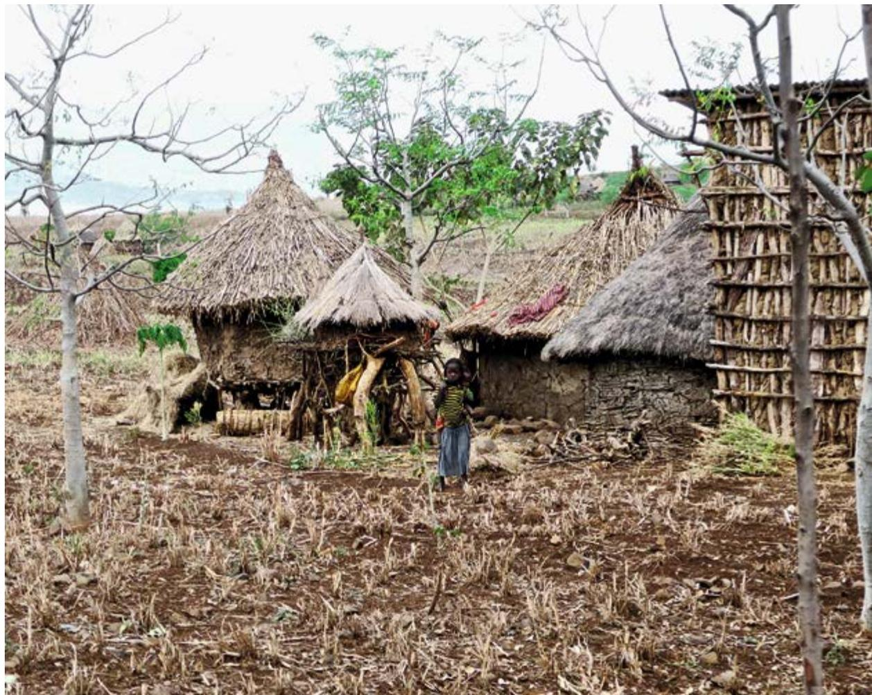
*Un esempio di case rurali etiopi: a sinistra le più antiche a cilindro, a destra quella rettangolare, costruita con rami verticali e orizzontali, che in seguito vengono rivestiti da un impasto di terra*
