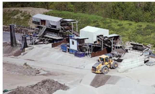
La nuova ubicazione e il potenziamento dell'impianto di vagliatura (demetallizzazione) delle scorie grezze gestito in discarica dalla ditta Hecor (foto maggio 2019)
