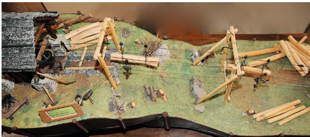
Modello di teleferica a fune continua (il cosiddetto "Fil a freno")
