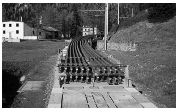
Un trasporto di 20 rotaie da 60 metri su carri di trasporto speciali. Nelle curve queste rotaie FFS, che possono pesare fino a 54 kg/m, si snodano senza problemi come lunghi serpenti
