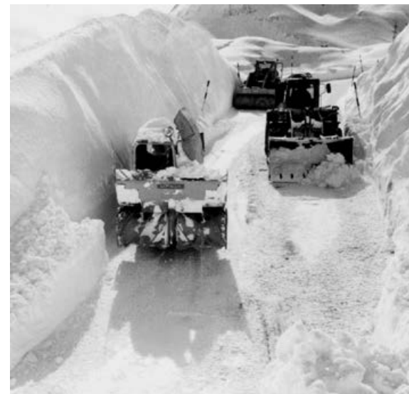
Gennaio 2001 in zona "Baraccone": si sta liberando la strada dalle forti nevicate con l'intervento di due fresatrici e uno spazzaneve
