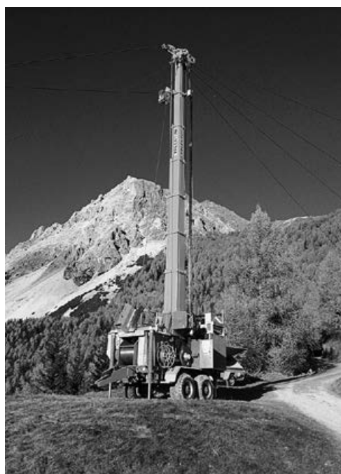
La torre telescopica di 12 metri della nuova teleferica posizionata a Sassiglion in occasione di un esbosco
