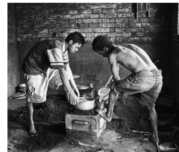
L'alluminio liquefatto viene versato in uno stampo fatto di terra. Tutta l'operazione a piedi nudi! In poco tempo hanno costruito una pentola
