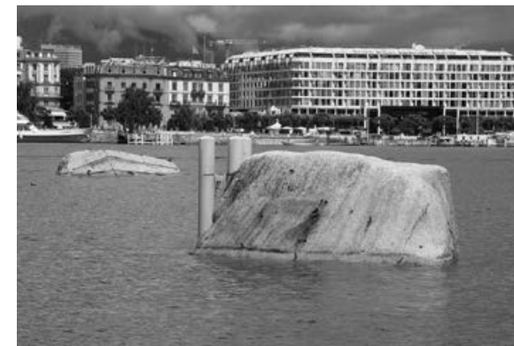
La pietra "Repère Pierre du Niton", nel porto di Ginevra; è il punto di riferimento per tutte le misurazioni altimetriche (m.s.l.m.) del territorio svizzero
