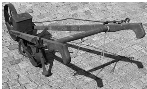
Attrezzo per la semina, a sinistra il meccanismo per variare la distanza fra seme e seme, a destra il freno
