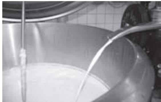
...a sinistra scende il latte in un apposito contenitore che lo mantiene costantemente a 4 gradi
