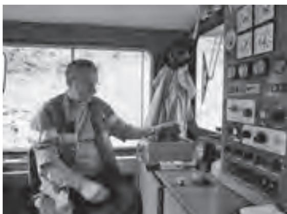
**Sergio Bracelli sul trattore di manovra allo scalo di Campocologno. Nell'ambito dello scalo i binari non sono dotati di catenaria e quindi va usato un trattore a trazione Diesel idraulica.**
